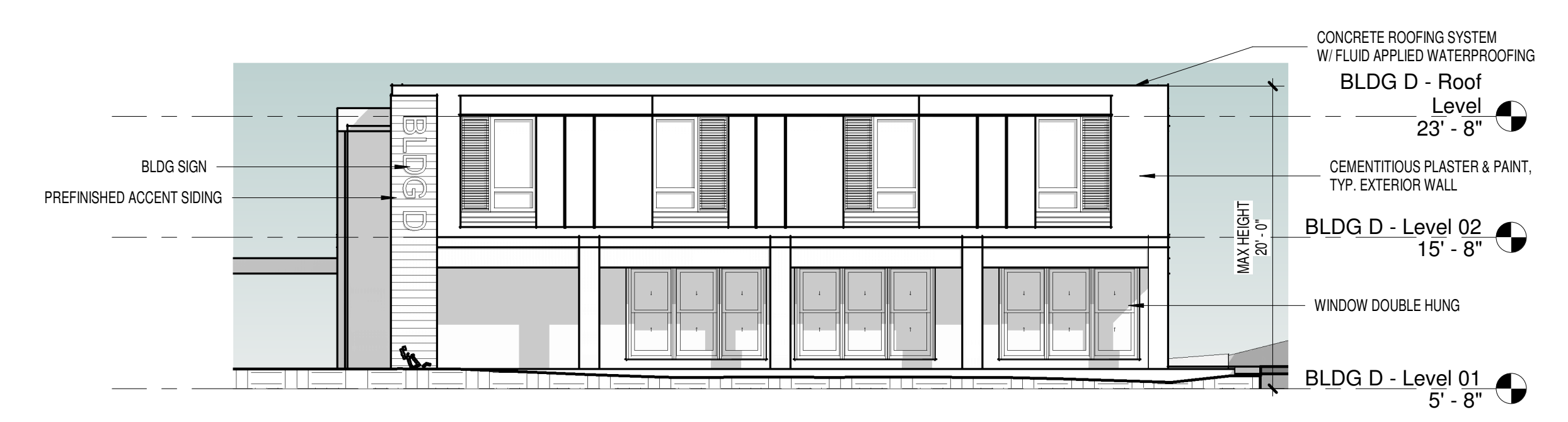
3 BLDG D - NORTH ELEVATION A-D2.0 SCALE: 1/8" = 1'-0"
